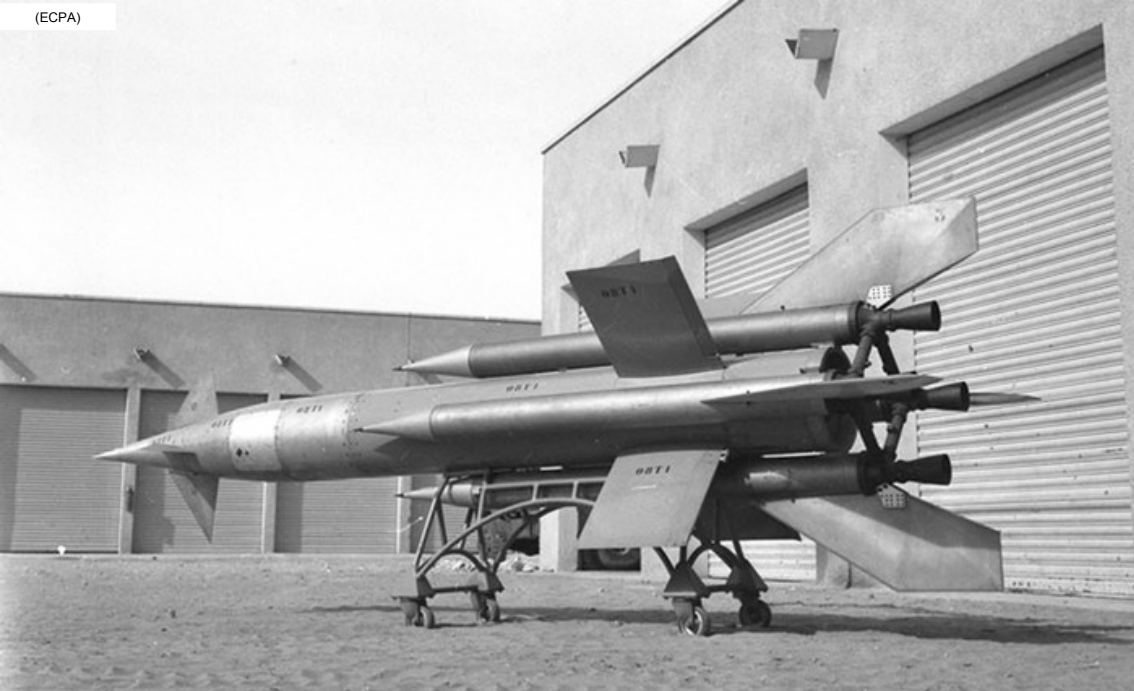
Missile antiaérien radioguidé à statoréacteur PARCA, en 1958
