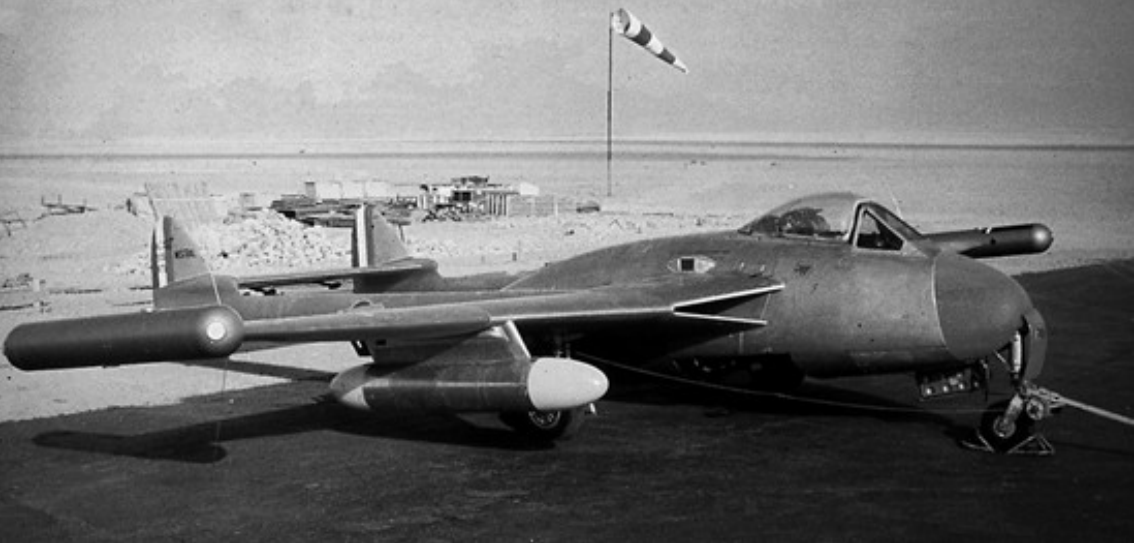
Mistral téléguidé – Un dizaine de Mistral téléguidés ont été utilisés afin de servir de cibles radioguidées pour la mise au point des missiles air-air – Les missiles tirés n'étaient pas tous à charge explosive et les avions sont dotés de bidons-caméras spéciaux fixés sous les ailes. D'autres bidons, fixés en bouts d'ailes, sont équipés de dispositifs proximétriques associés à un jeu de caméras – Ces Mistral sont les derniers avions de ce type maintenus en état de vol.
