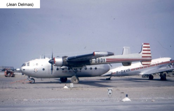
Les Nord 2502B, avec des réacteurs en bouts d'ailes, utilisés par Air Algérie pour le transport de personnel et de matériel
